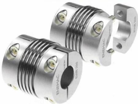
Die Metallbalgkupplung im Hygienic Design ist in 7 Baugrößen für Nennmomente von 10 Nm bis 1.200 Nm und für Wellendurchmesser von 7 bis 85 mm erhältlich
