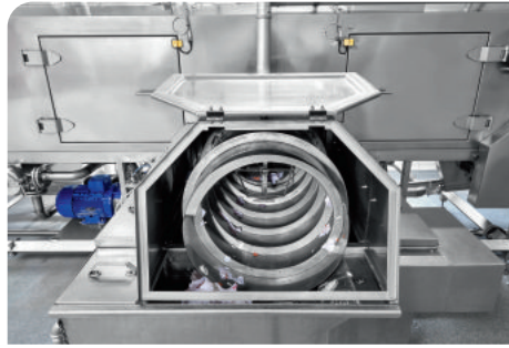
Die entfernten Etiketten werden über seitlich integrierte Trommelfilter an den großzügig dimensionierten Tanks ausgetragen. Foto: Mohn
