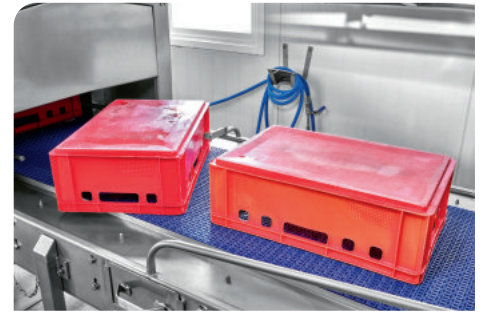
Antriebstrennzone mit Drehvorrichtung: Für die Drehung der Behälter von Quer- auf Längsrichtung. Foto: Mohn
