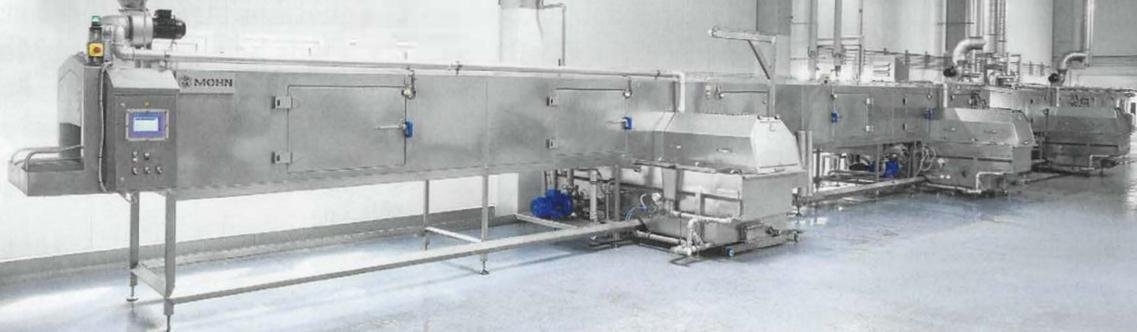
Die hochmoderne 3-Tank-Waschanlage von Mohn ermöglicht beim Kalbfleischproduzenten Bahlmann die effiziente Reinigung von Euronorm-Behältern im Durchlaufverfahren.
