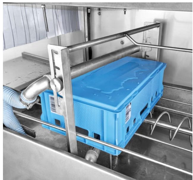
Typ DLWA-A 180 Ecoline, Detail Luftmesser
